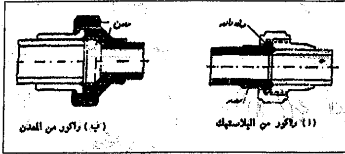
شكل (٢-٣٩) وصل المواسير البلاستيك بالمواسير المعدنية
